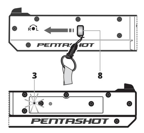
Após o teste da pilha, o indicador LED permanece fixo a azul para indicar que o laser está ligado e pronto a ser utilizado.
