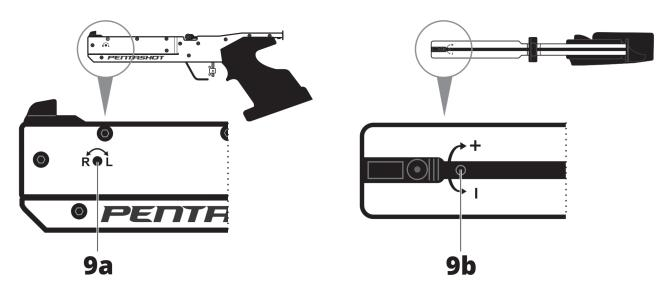
IMPORTANTE: O movimento dos parafusos de ajuste deve ser muito ligeiro. Uma volta do parafuso de ajuste permite mover o ponto laser cerca de 20 cm a 10 m de distância.
