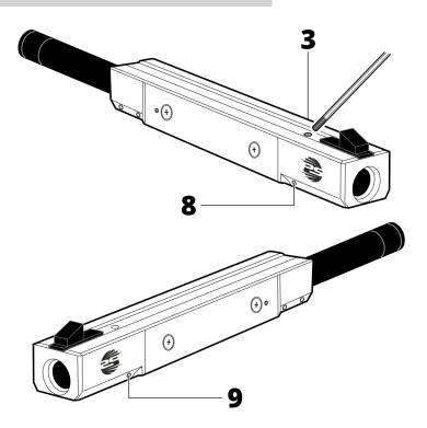
Para ajustar a posição dos ponto/feixe laser **PARA CIMA** e **PARA BAIXO**, aperte o parafuso (3) na parte superior do cano com laser e os parafusos (8) e (9) na parte lateral do cano com laser:
